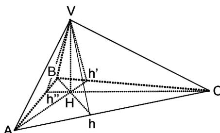
Las alturas de la base son  $Bh$ ,  $Ah'$  y  $Ch''$ , que se cortan en el ortocentro  $H$ . El plano  $VBh$  es perpendicular a  $AC$ , y el plano  $VAh'$  lo es a  $BC$ . Luego  $VH$  es perpendicular a  $AC$  y a  $BC$ , siéndolo por tanto, al plano  $ABC$ . Luego  $H$  es la proyección de  $V$  sobre  $ABC$ .
