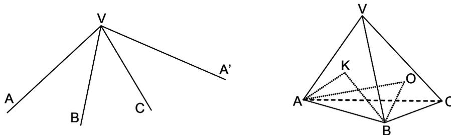
1º) Desarrollando el triedro sobre el plano de una de sus caras (por ejemplo  $VBC$  en la figura de la izquierda) y fijando una longitud arbitraria  $VA = VA'$ , se tiene que:
