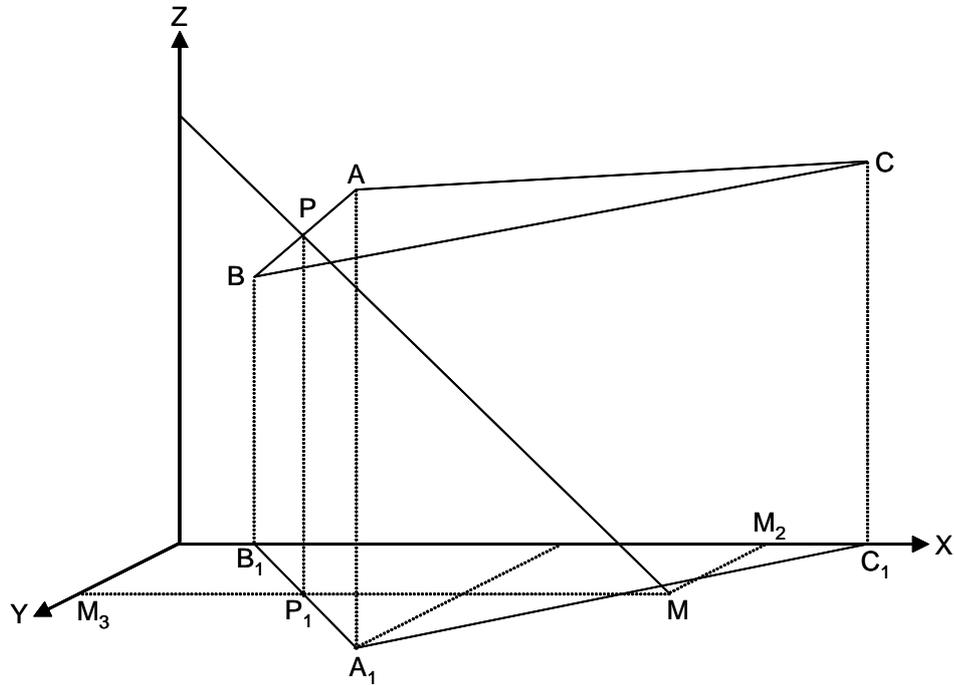
El ángulo  $XOY$  es  $\arctan\left(-\frac{1}{2}\right) = 153^\circ 43'$ , y el coeficiente  $\mu = \frac{2}{3}$ .  $MP$  es la recta paralela, y  $P$  es el punto de intersección con  $ABC$ .
