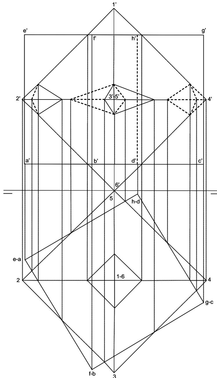
Los vértices del octaedro son 1, 2, 3, 4, 5 y 6, este último sobre el plano  $H$ . El vértice 5 está apoyado en el plano  $V$ . Los vértices del cubo son  $abcdefgh$ , los cuatro primeros en la cara inferior. La sección principal del octaedro pasa por los vértices 1 y 6, y por los puntos medios de las aristas opuestas  $2-3$  y  $4-5$ , formando un ángulo de  $45^\circ$  con  $V$ . Los planos  $adeh$  y  $bcfg$  forman un ángulo de  $15^\circ$  con  $V$ .
