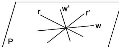
En el plano  $P$  formado por las dos rectas  $r$  y  $r'$ , se trazan las bisectrices  $w$  y  $w'$ . Levantando por  $w$  y  $w'$  planos perpendiculares al formado por  $r$  y  $r'$ , se obtiene el lugar pedido.
