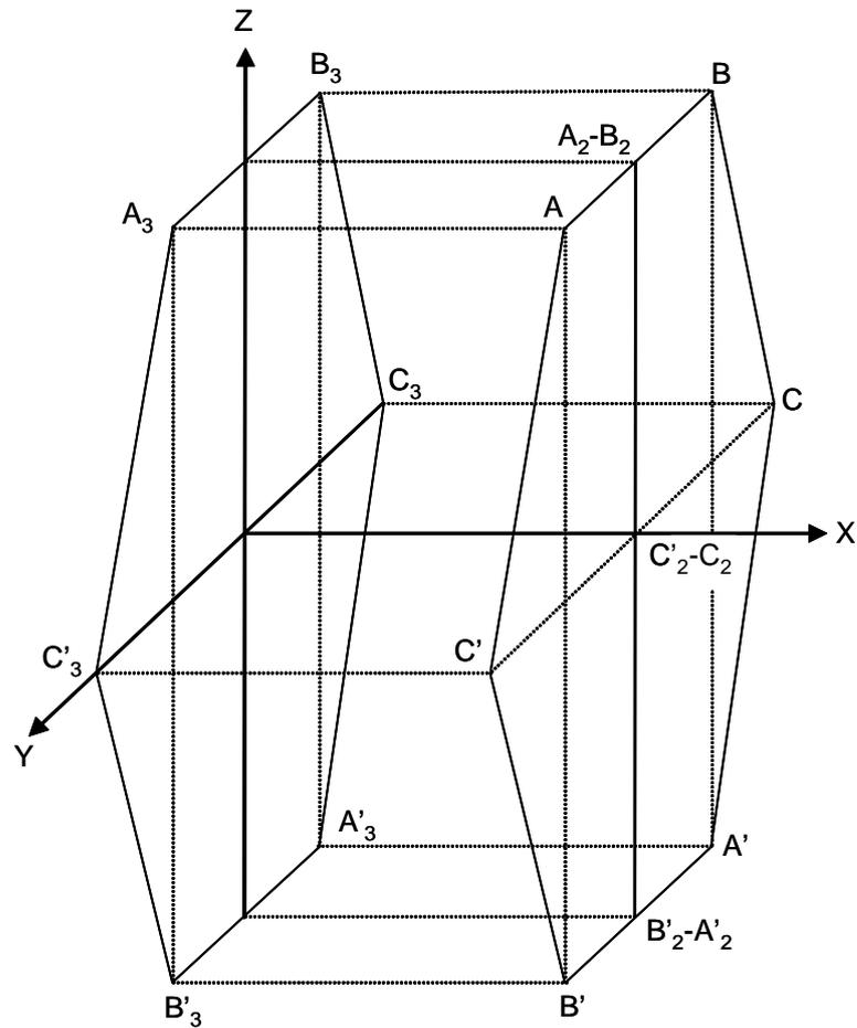
La proyección sobre el plano  $XZ$  es la recta  $A_2 - A'_2$ . La proyección sobre  $YZ$  es el exágono  $A_3B_3C_3A'_3B'_3C'_3$ .
