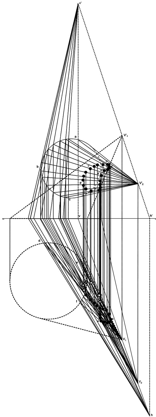
L 9- Representar en el sistema diédrico el cuerpo formado por un cubo y un octaedro concéntricos, ambos de arista 4cm, El octaedro tiene una diagonal perpendicular al plano horizontal  $H$  y apoyada sobre él, formando el plano de su sección principal un ángulo de  $45^\circ$  con el plano vertical  $V$ . El cubo tiene sus bases paralelas al plano horizontal  $H$ , y una de sus caras verticales forma un ángulo de  $15^\circ$  con el plano vertical  $V$ .
