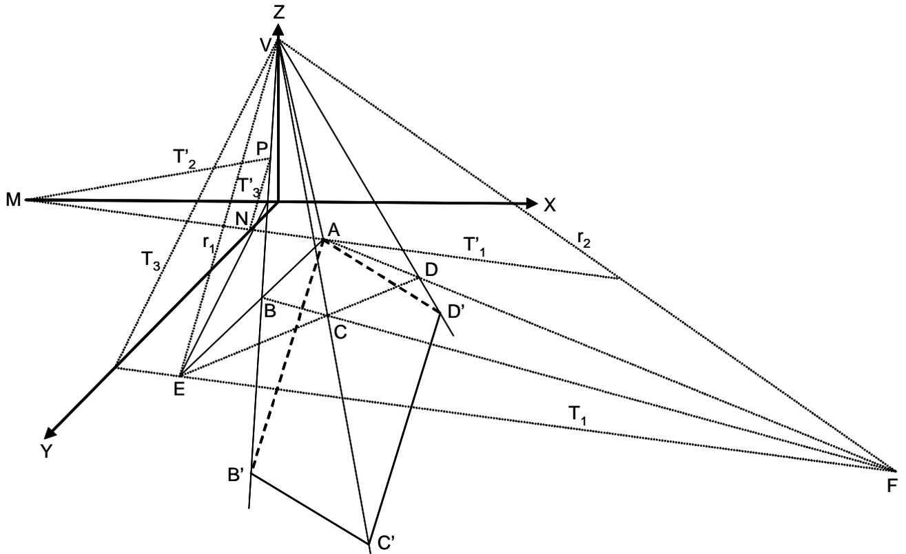
1. Las caras  $AVB$  y  $CVD$  se cortan en la recta  $r_1$ , y las caras  $BVC$  y  $AVD$  en la  $r_2$ . Todo plano paralelo a estas dos rectas, corta a la pirámide según un paralelogramo. El plano paralelo que pasa por  $A$ , corta a las aristas en  $B'$ ,  $C'$  y  $D'$ . Las aristas  $B'C'$  y  $C'D'$  son vistas.
