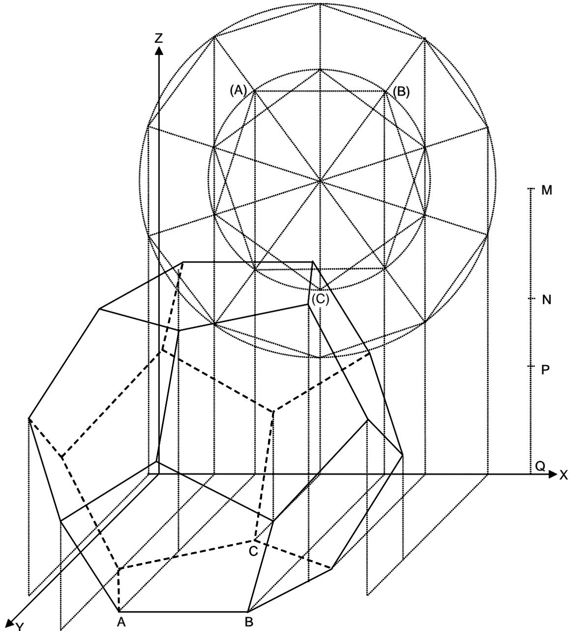
Abatiendo  $XY$  sobre  $XZ$ , se dibujan las proyecciones de los pentágonos de las caras superior e inferior, y el decágono sobre el que están las proyecciones de los vértices intermedios. Las cotas de sus planos se determinan en el croquis de la derecha.
