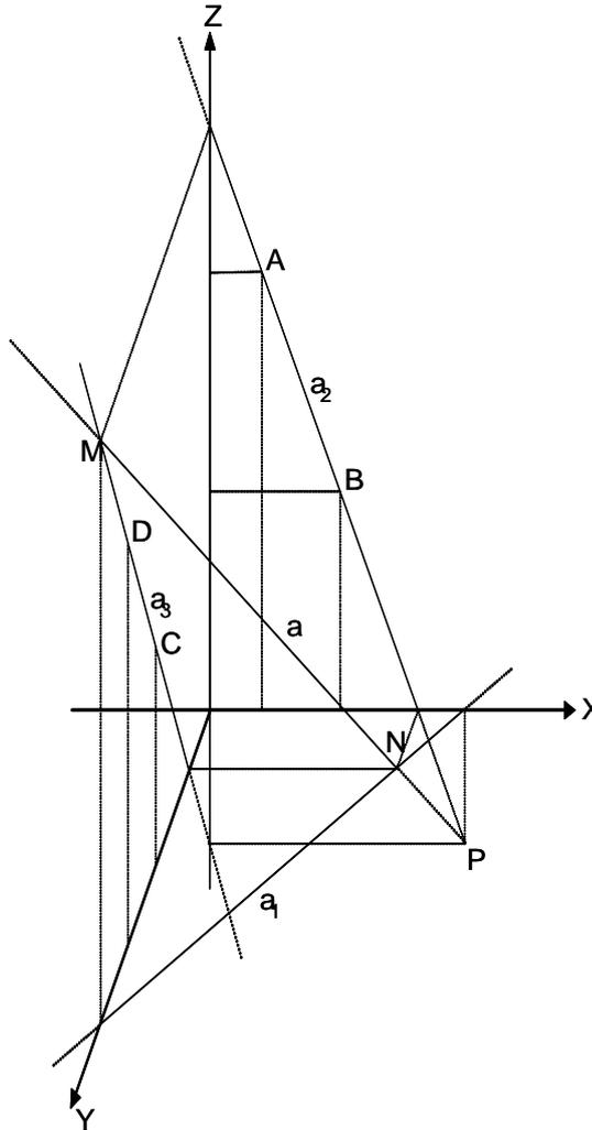
Las proyecciones de la recta son  $a_1$  sobre el plano  $XY$ ,  $a_2$  sobre el plano  $XZ$ , y  $a_3$  sobre el plano  $YZ$ . Sus trazas son  $M$  con el plano  $YZ$ ,  $N$  con el plano  $XY$  y  $P$  con el plano  $XZ$ .
