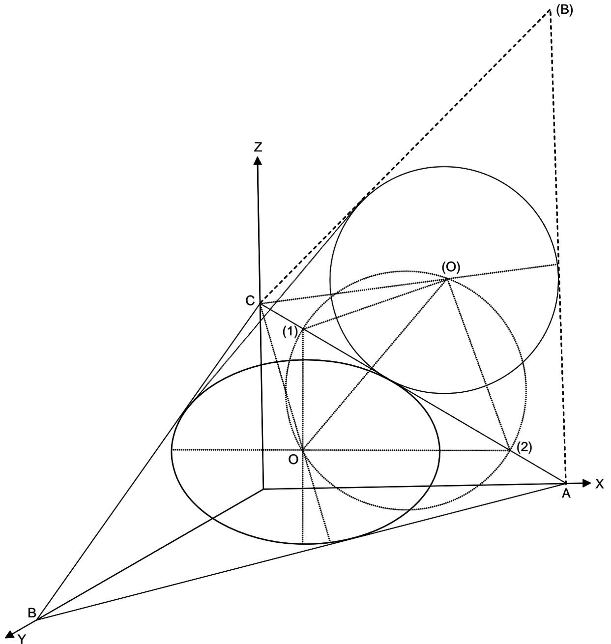
El ángulo  $XOY = 150^\circ$  y  $\mu = \frac{2}{3}$ . El triángulo de trazas  $ABC$ , se abate en el plano  $XZ$  en  $A(B)C$ . El círculo auxiliar corta a la charnela  $AC$  en (1) y (2).
