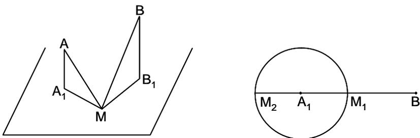
Sean  $A_1$  y  $B_1$  las proyecciones de  $A$  y  $B$  sobre el plano dado, siendo  $a$  y  $b$  sus cotas  $AA_1$  y  $BB_1$ . Siendo  $M$  un punto del lugar, los triángulos  $AMA_1$  y  $BMB_1$  son semejantes, luego  $\frac{A_1M}{B_1M} = \frac{a}{b}$ , por lo que en el plano dado el lugar es una circunferencia de diámetro  $M_1M_2$ , siendo estos puntos los que dividen el segmento  $A_1B_1$  en la relación  $\frac{a}{b}$ .
