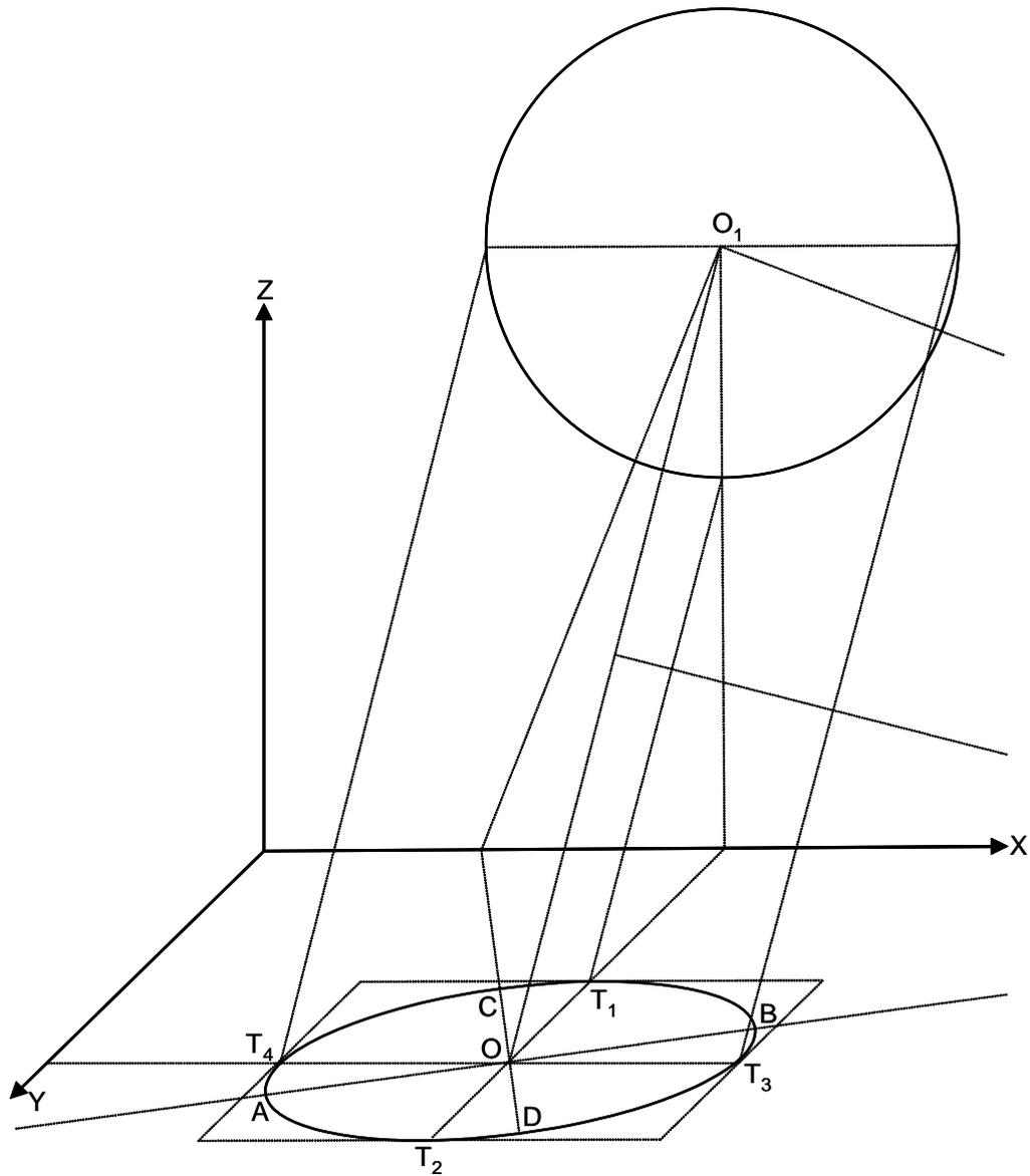
Se han marcado los puntos de tangencia  $T_1, T_2, T_3$  y  $T_4$ , y se han trazado las correspondientes tangentes. Los ejes de la elipse son  $AB$  y  $CD$ .
