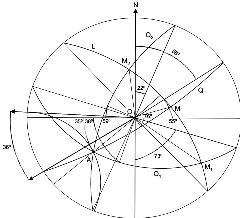
Flancos =  $Q_1$  y  $Q_2$ . Charnela =  $OA$ ; Inmersión =  $35^\circ$ . Plano perpendicular a  $OA = L$ . Plano bisector de  $Q_1$  y  $Q_2 = Q$  ( $d = 56^\circ$ ;  $i = 76^\circ$ ;  $b = SE$ ). Cabeceo =  $36^\circ$ .
