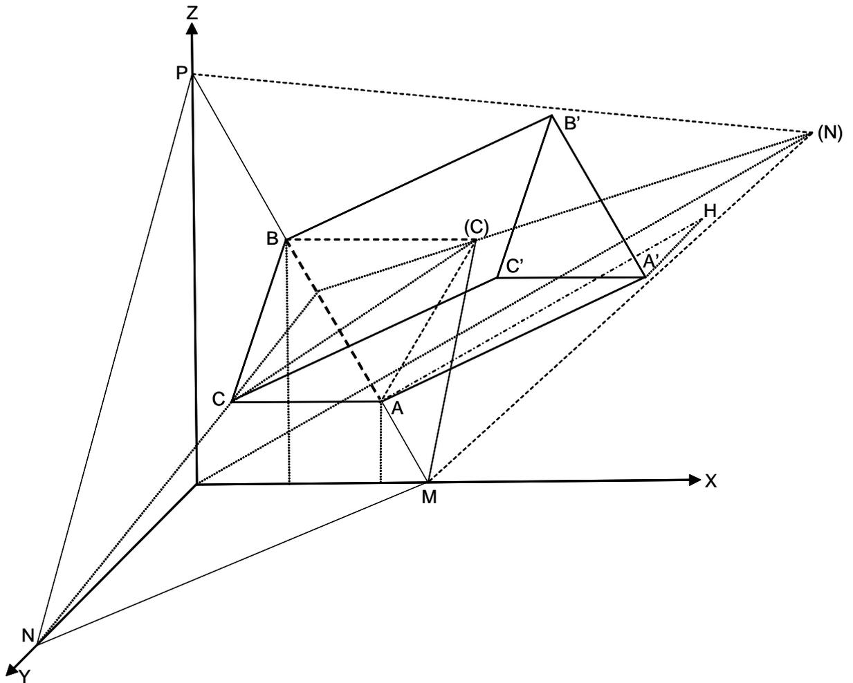
(C) es el abatimiento de C, charnela  $AB$ , siendo equilátero el triángulo  $AB(C)$ . El triángulo  $A'B'C'$  es igual al  $ABC$ , estando su plano situado a una distancia 8 cm del plano de aquel.
