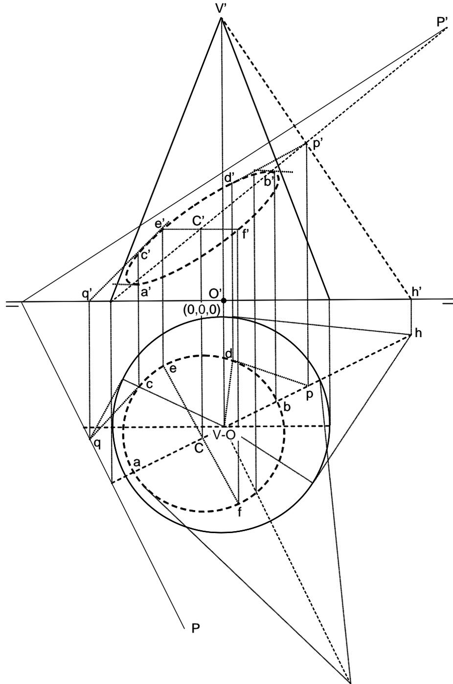
La intersección es la elipse cuyas proyecciones se han dibujado de trazos. En la proyección vertical se han dibujado las tangentes más arriba y más abajo en los puntos  $b'$  y  $a'$ , respectivamente. En la proyección horizontal se han dibujado los ejes  $ab$  y  $ef$ , y en la vertical los diámetros conjugados  $a'b'$  y  $e'f'$ . Se han dibujado las tangentes  $qc - q'c'$  y  $pd - p'd'$ .
