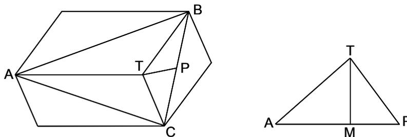
El volumen del romboedro es seis veces el del tetraedro  $TABC$ , cuya base es un triángulo equilátero de lado  $d$ , y cuya altura es la del triángulo  $ATP$  sobre su base  $AP$ , siendo  $P$  el punto medio de  $BC$ . Por tanto  $V = 6 \cdot \frac{1}{3} \cdot \frac{d^2 \sqrt{3}}{4} \cdot \sqrt{\frac{3a^2 - d^2}{3}} = \frac{d^2 \sqrt{3a^2 - d^2}}{2}$ .
