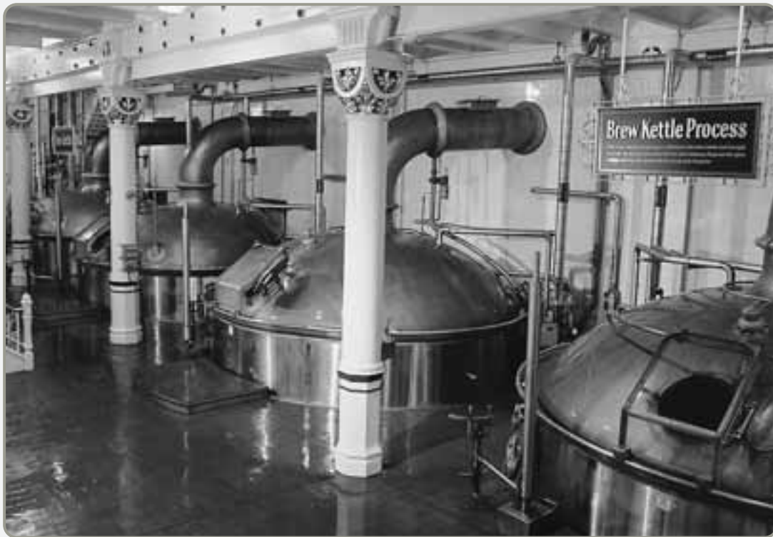
▲ En la fotografía se muestran las calderas donde el mosto, que se convertirá en cerveza, se hierve y al cual se le agrega lúpulo para obtener el sabor y amargor característicos.
