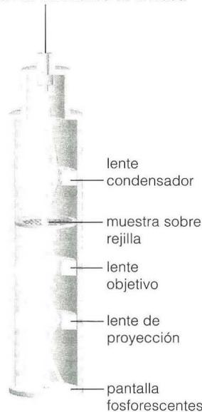
**B** Microscopio de transmisión electrónica (MTE). Los electrones que atraviesan un corte delgado de una muestra, iluminan una pantalla fluorescente. Los detalles internos de la muestra forman sombras visibles, como se ve en la figura 4.8d.
