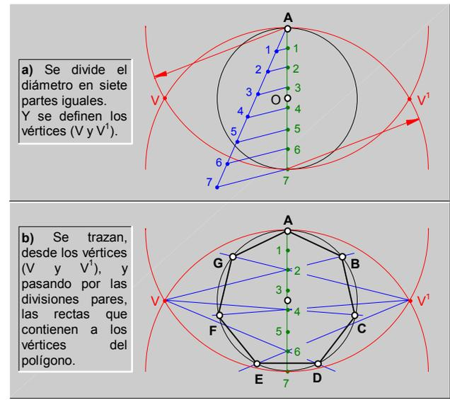
fig.37.\ Dibujo de un heptágono regular, (Método general).
