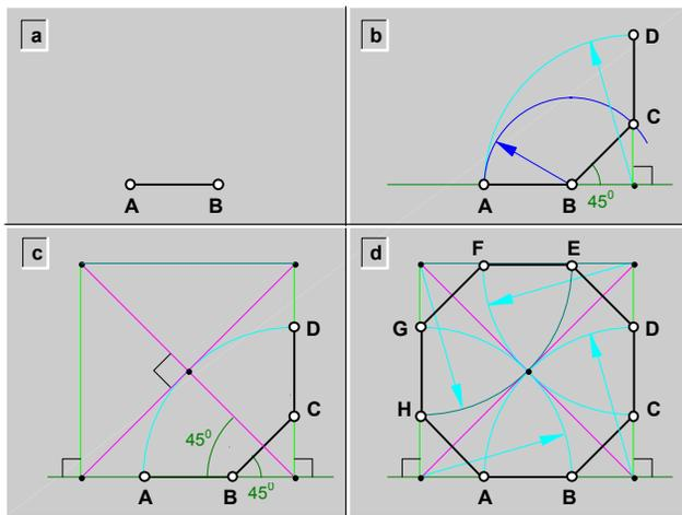
fig.34.\ Dibujo de un octágono regular (ABCDEFGH), conocido el lado (AB).
