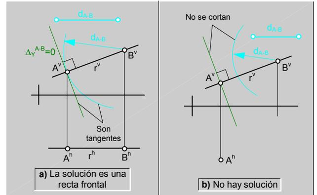
fig.112.\ Construcción de rectas (PV + VT) \ casos particulares.
