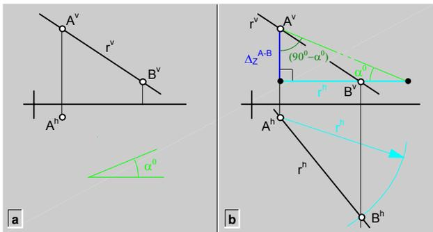
fig.105.\ Construcción de rectas (PV +  $\alpha^0$ ).
