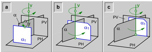
fig.250.\ Rotación de un plano ( $\alpha$ ) en posición vertical a una posición ( $\alpha_1$ ) frontal.
