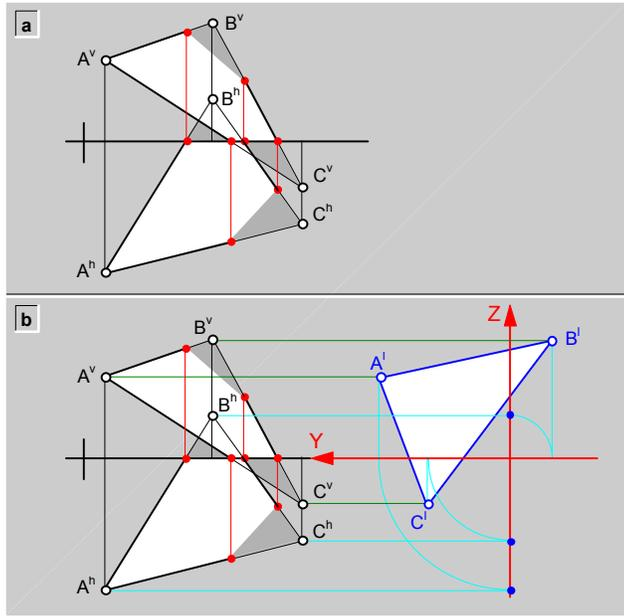
fig.80.1 Proyección lateral de un triángulo (A;B;C).
