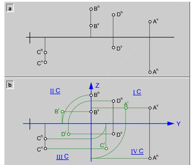
fig.79.\ Obtención de las proyecciones laterales a partir de la doble proyección ortogonal ejemplo.
