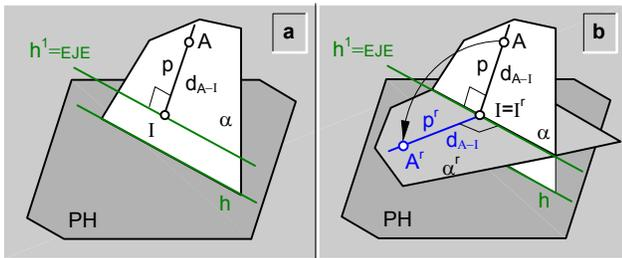
fig.228.\ Rebatimiento a través de una recta característica horizontal ( $h^1$ ) del plano ( $\alpha$ ).
