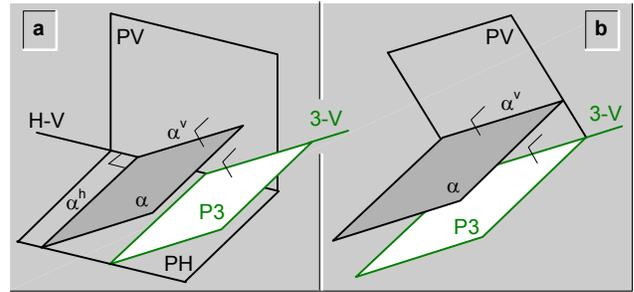
fig.265.\ Cambio del plano horizontal de proyección, para observar en posición horizontal a un plano de punta.
