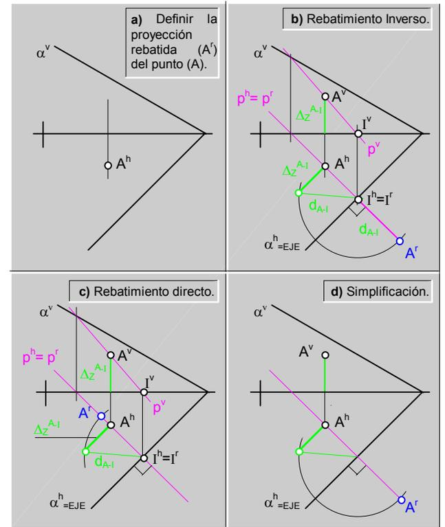
fig.219. \ Rebatimiento a través de la traza horizontal.
