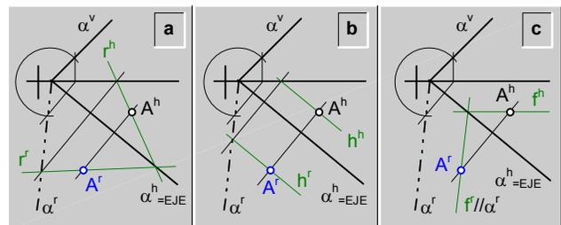
fig.222.\ Rebatimiento de un punto (A), por medio del rebatimiento previo de la traza vertical del plano.
