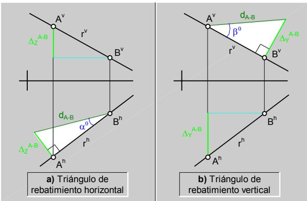
fig.91. \ Dibujo de los triángulos de rebatimiento.
