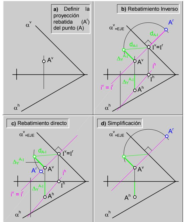
fig.224.\ Rebatimiento a través de la traza vertical.
