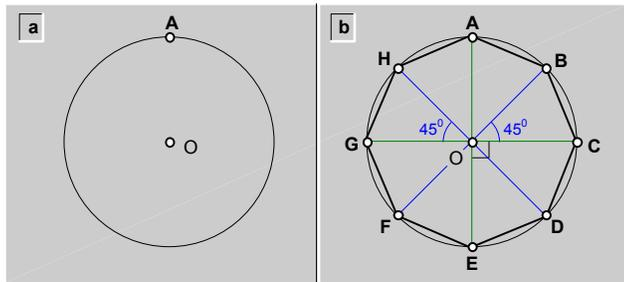
fig.35.\ Dibujo de un octágono regular (ABCDEFGH), conocido el vértice (A) y la circunferencia que lo circunscribe.
