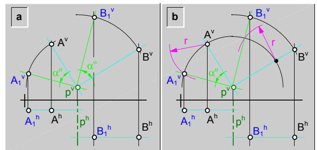
fig.244.\ Rotación simultánea de varios puntos.
