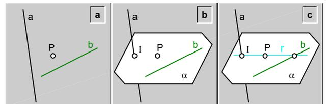
fig.201.\ Recta (r) que se corta con dos rectas (a y b) dadas y pasa por un punto (P) dado.
