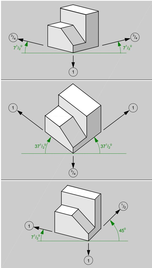
fig.51.\ Proyecciones dimétricas.
