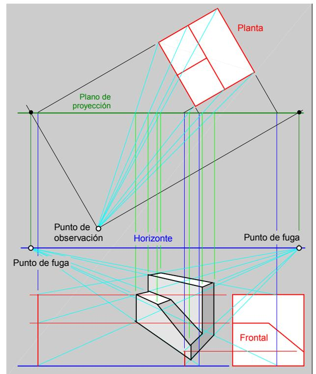
fig.63.\ Dibujo de una perspectiva de dos puntos de fuga.
