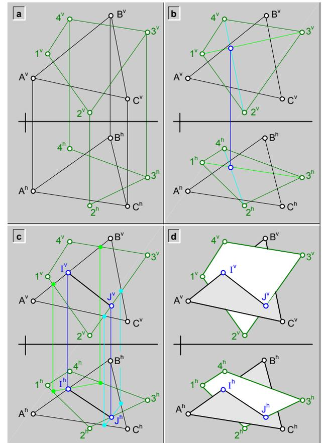
fig.154.\ Intersección y visibilidad de dos planos\ ejemplo.
