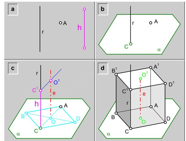
**fig.305.** Construcción de un prisma regular recto, conocida su altura, un vértice y una recta que contiene a una arista principal.
