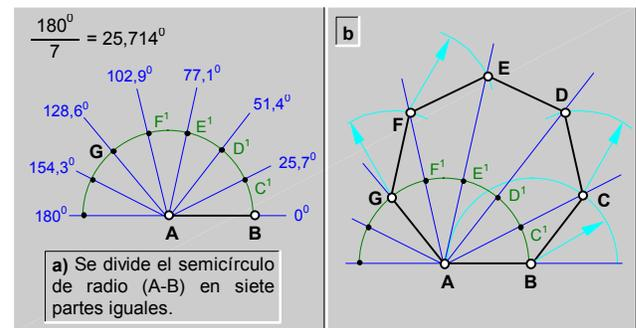
fig.38.\ Dibujo de un heptágono regular, (Método general).
