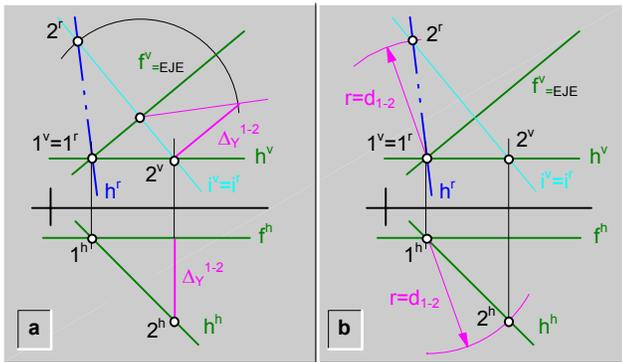
fig.236.\ Rebatimiento de una horizontal (h) de un plano (α).
