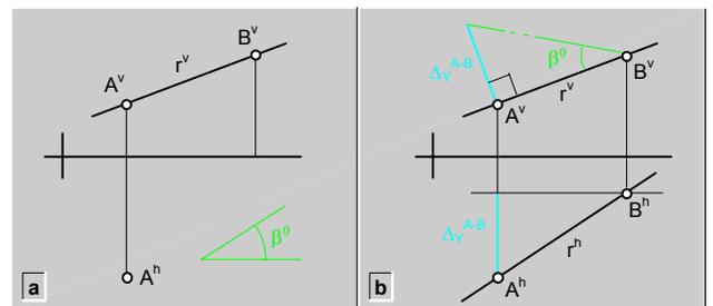
fig.103. Construcción de rectas (PV +  $\beta^0$ ).
