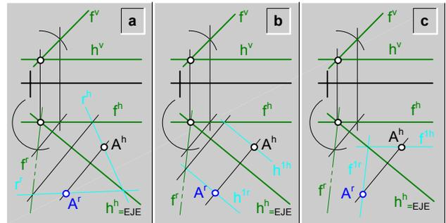
fig.232.\ Rebatimiento de un punto (A) de un plano ( $\alpha$ ) por medio del rebatimiento previo de una recta frontal (f).
