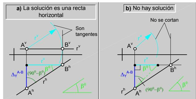
fig.108.\ Construcción de rectas (PH +  $\beta^0$ ) \ casos particulares.
