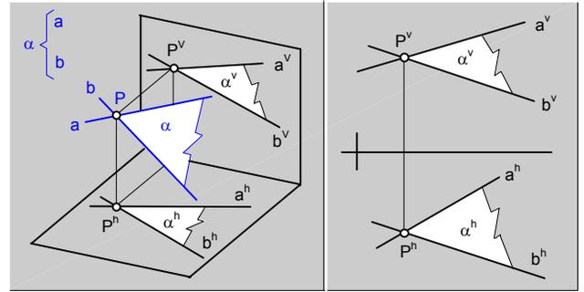
Fig.119. Plano ( $\alpha$ ) definido por dos rectas (a y b) que se cortan.
