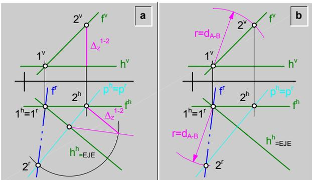
fig.231.\ Rebatimiento de una frontal de un plano ( $\alpha$ ).
