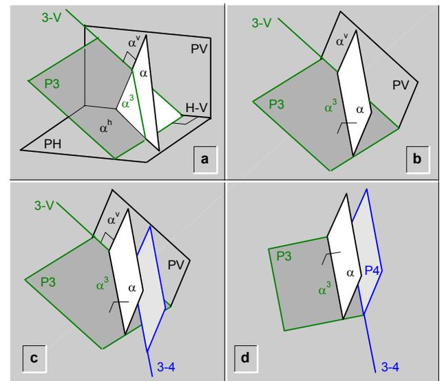
fig.273. Observación de un plano en posición frontal por medio de dos cambios de plano.
