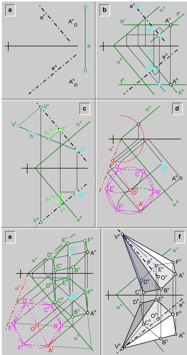
**fig.295.\ Construcción de una pirámide regular recta conocido: la altura (h); un vértice (A) de la base; y una recta (e) que contiene al eje\ ejemplo.**
