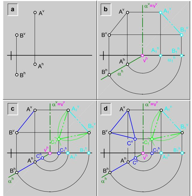
fig.251.\ Rotación de un plano vertical a una posición frontal.
