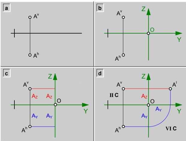
fig.78.\ Determinación de la proyección lateral de un punto (A), a partir de su doble proyección ortogonal.
