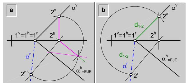
fig.221.\ Rebatimiento de la traza vertical de un plano.
