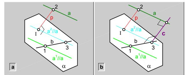
fig.189. \ Perpendicular común (c) a dos rectas (a y b) que se cruzan.
