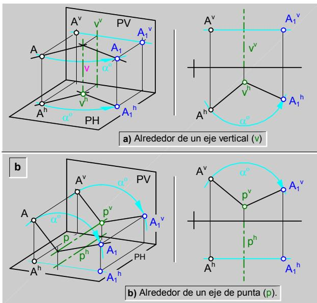
fig.242.\ Rotación de un punto (A) hasta la posición (A<sub>1</sub>).
