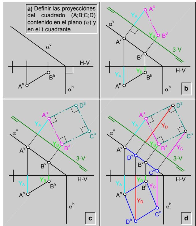
fig.266.\ Cambio del plano horizontal de proyección, para observar en posición horizontal a un plano de punta ejemplo.
