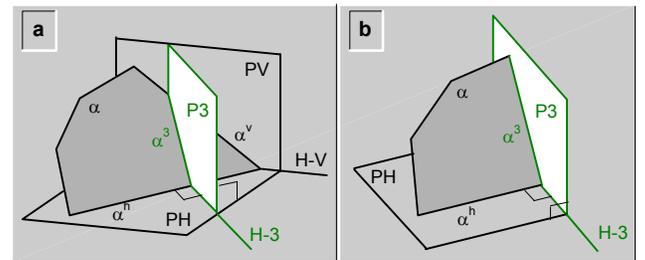
fig.263.\ Cambio del plano vertical de proyección, para observar en posición de punta a un plano cualquiera.
