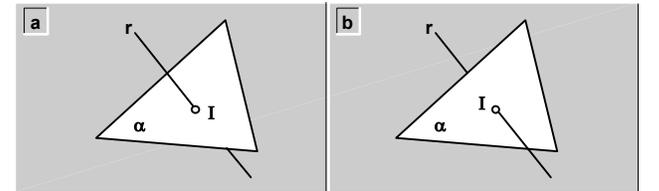
fig.147. Intersección entre una recta y un plano \ VISIBILIDAD.
