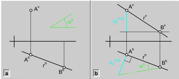
fig.104.\ Construcción de rectas (PH +  $\alpha$ ).
