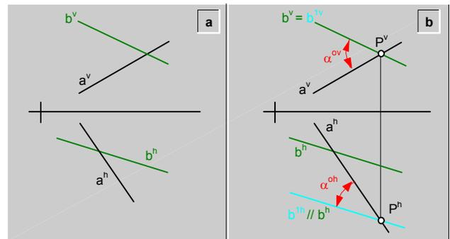
fig.192. Ángulo ( $\alpha^\circ$ ) entre dos rectas (a y b) que se cruzan.
