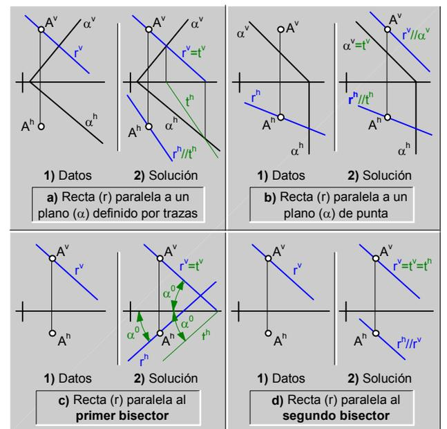
fig.159. \ Recta (r) paralela a un plano ( $\alpha$ ) ejemplos.
