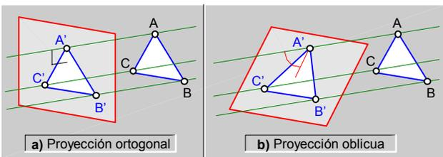
fig.44.\ Proyección cilíndrica.
