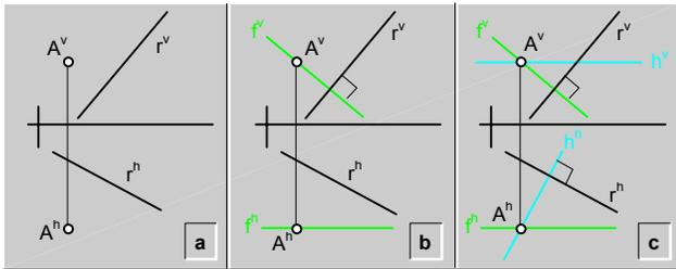
fig.172. Plano ( $\alpha$ ), que contiene a un punto (A) y es perpendicular a una recta (r).
