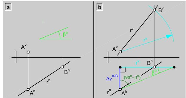
fig.107.\ Construcción de rectas (PH +  $\beta^0$ ).
