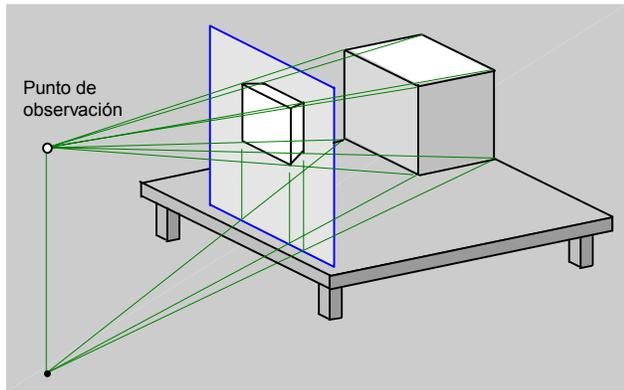
fig.59.\ Perspectiva de un punto de fuga.
