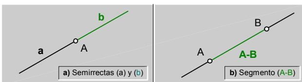
fig.3.\ Partes de una Recta.
