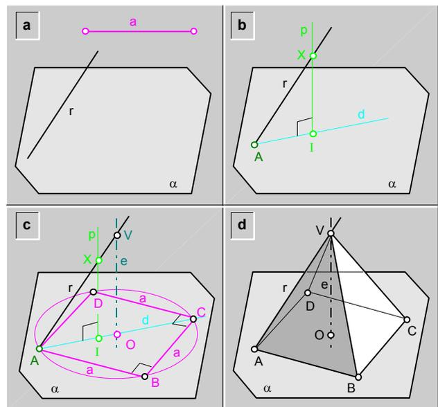
**fig.296.\ Construcción de una pirámide regular recta, conocido el plano de la base; una recta que contiene a una arista principal; y la longitud (a) de las aristas de la base.**
