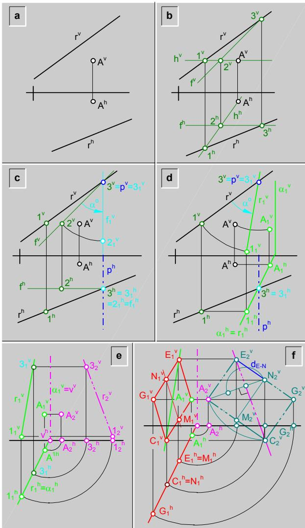
fig.292.1 Construcción de un cubo conocido un vértice (A) y una recta (r) que contiene a una diagonal mayor (E-C) ejemplo.
