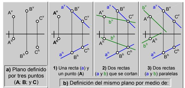
Fig.122. Cambio de la definición original de un plano.
