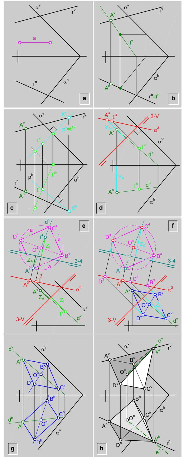
**fig.297.** Construcción de una pirámide regular recta, conocido el plano base; una recta que contiene a una arista principal; y la longitud de las aristas de la base \ ejemplo.
