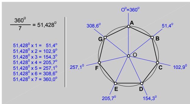
fig.36.\ Dibujo de un heptágono regular, (Método general).
