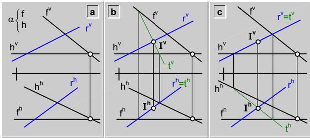
fig.144. Intersección (I) de la recta (r) con el plano ( $\alpha$ ) definido por rectas características (f y h).
