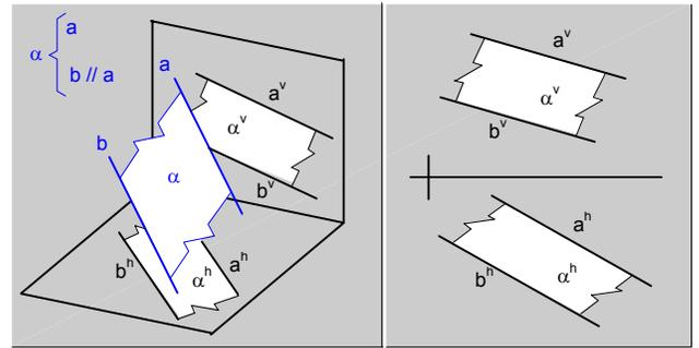
Fig.120. Plano ( $\alpha$ ) definido por dos rectas (a y b) paralelas.
