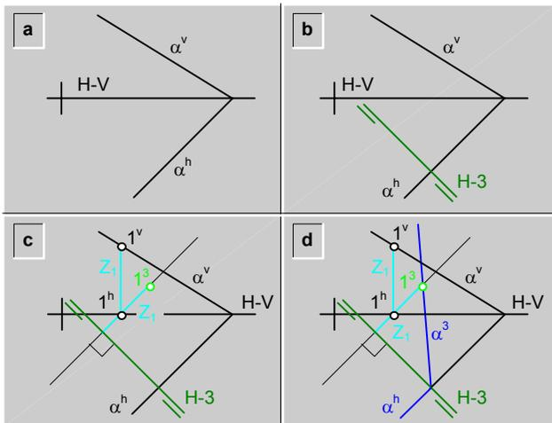
fig.264.\ Cambio del plano vertical de proyección, para observar en posición de punta a un plano cualquiera ejemplo.
