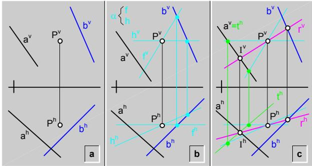
fig.202.\ Recta (r) que se corta con dos rectas (a y b) dadas y pasa por un punto (P) dado\ ejemplo.
