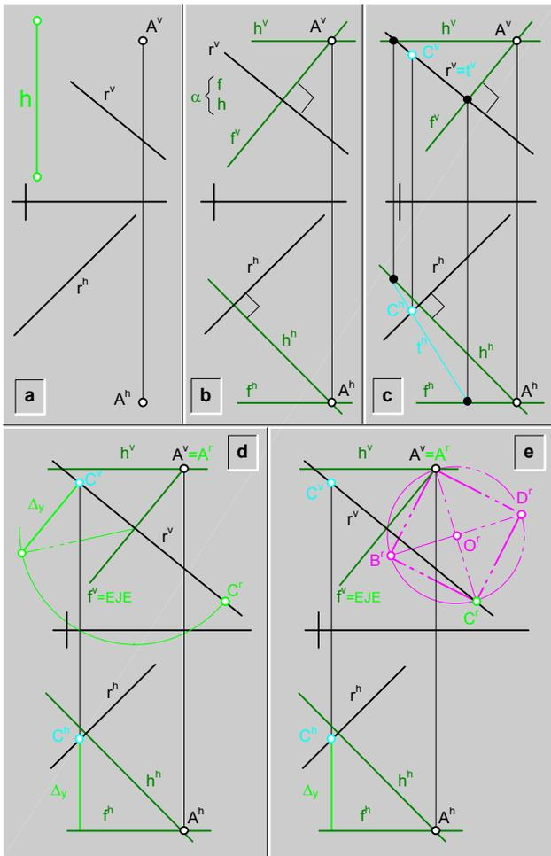
**fig.306.a.** Construcción de un prisma regular recto de base cuadrada ( $ABCD$ ), conocido el vértice ( $A$ ), la altura ( $h$ ), y la recta ( $r$ ), que contiene a la arista principal ( $C-C^1$ ) ejemplo.
