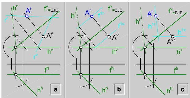
fig.237.\ Rebatimiento de un punto (A) de un plano (α) por medio del rebatimiento previo de una recta horizontal (h).
