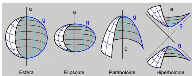
fig.12.\ Superficies de doble curvatura.
