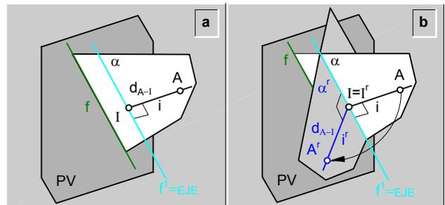
fig.233.\ Rebatimiento a través de una recta característica frontal ( $f^1$ ) de un plano ( $\alpha$ ).
