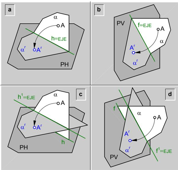
fig.215. \ Rebatimiento de un plano ( $\alpha$ ).
