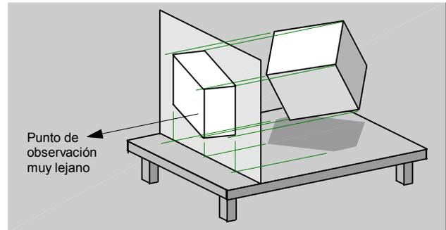
fig.49. \ Proyección axonométrica.
