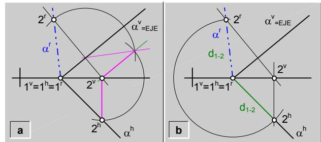
fig.226.\ Rebatimiento de la traza horizontal de un plano.
