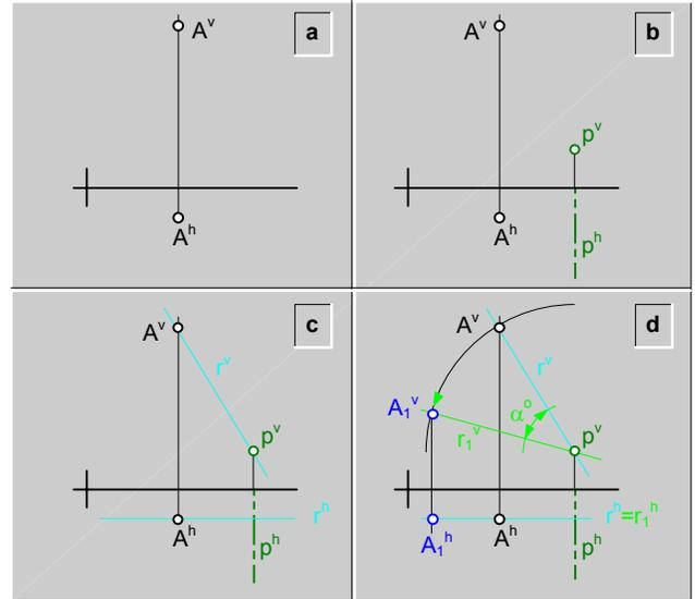
fig.243.\ Rotación alrededor de un eje de punta.
