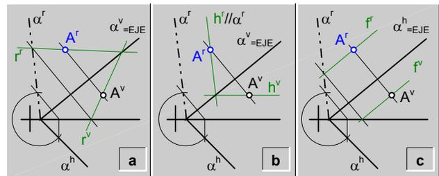
fig.227.\ Rebatimiento de un punto (A) por medio del rebatimiento previo de la traza horizontal del plano.
