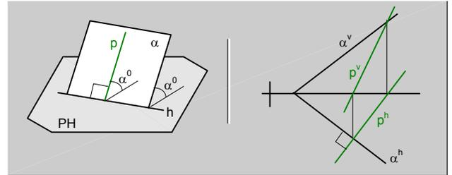
fig.175. Recta (p) de máxima pendiente de un plano ( $\alpha$ ).
