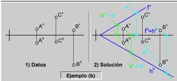
fig.128. Determinación de las trazas de un plano ejemplos.
