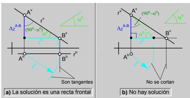
fig.106.\ Construcción de rectas (PV +  $\alpha^0$ ) \ casos particulares.
