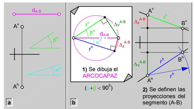
fig.113.\ Construcción de rectas (VT +  $\alpha^0$  +  $\beta^0$ ).
