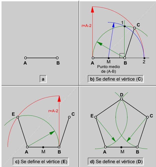
**fig.28.** Dibujo de un pentágono regular (ABCDE), conocido el lado (AB).
