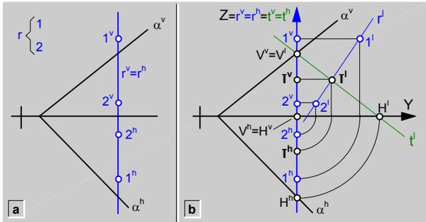
fig.145. Intersección (I) de un plano ( $\alpha$ ) definido por trazas, con una recta (r) de perfil.
