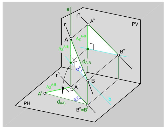
fig.89. Triángulo de abatimiento horizontal.
