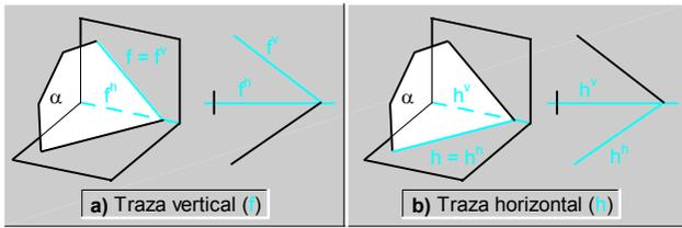
Fig.126. Trazas de un plano.
