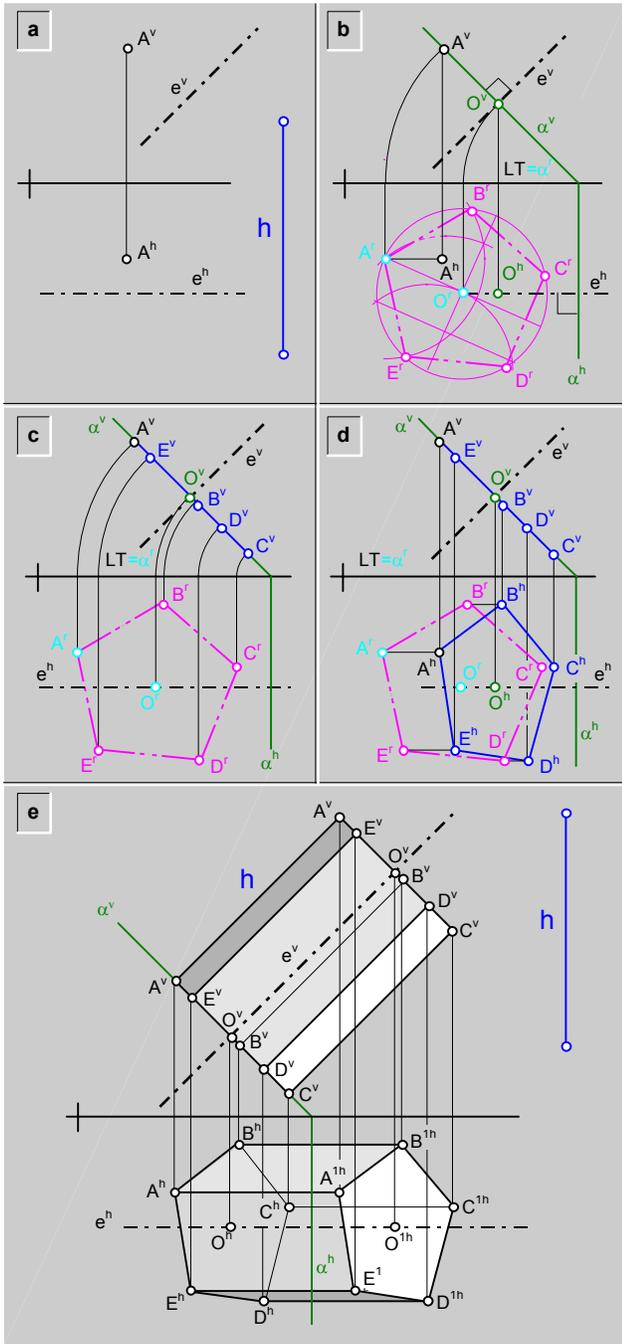
**fig.304.** Construcción de un prisma regular recto de base pentagonal (ABCDE), conocido: la altura (h); el vértice (A) de la base (ABCDE); y la recta (e) que contiene al eje ejemplo.
