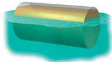
El barril no está completamente lleno de aceite, 0.2 pies de la parte superior del barril está vacía.
