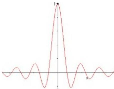
Figura 2.2: Discontinuidad evitable en  $x = 0$
