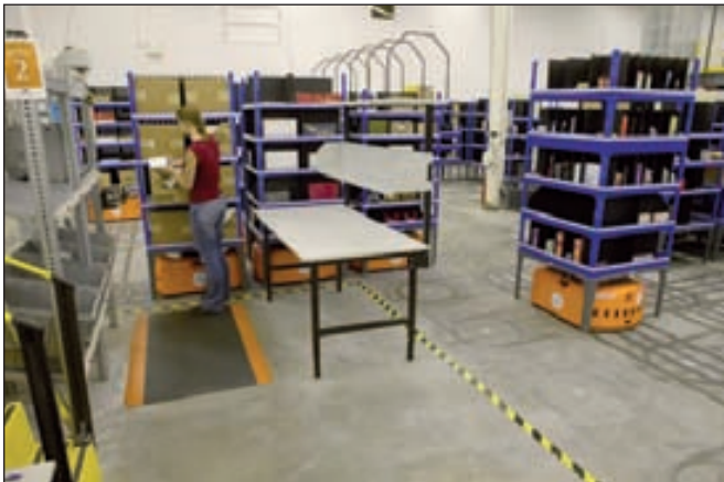
Los robots de Kiva Systems, Inc., llevan los carros de anaqueles del inventario directamente a los operadores en la nueva estrategia de manejo del material para cubrir pedidos.
