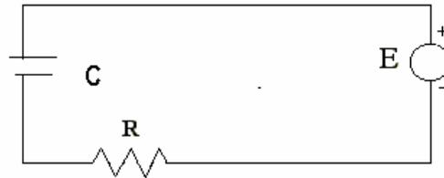
Supongamos que una resistencia de  $R$  ohmios varía con el tiempo  $t$  (segundos), de acuerdo a  $R = 1 + 0,01 t$ ,  $0 \leq t \leq 1000$ . Se conecta en serie con un condensador de  $0,1$  faradios y una f.e.m. de  $100$  voltios. La carga inicial en el condensador es de  $5$  culombios. Se trata de encontrar a) la carga y la corriente como una función del tiempo. b) la carga máxima teórica.
