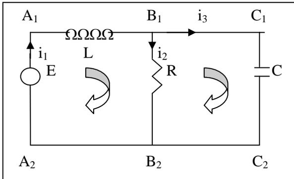
Determinar  $i_1, i_2, i_3$ , si  $E = 60$  voltios,  $L = 1$  henrio,  $R = 50$  ohmios,  $C = 10^{-4}$  faradios y se dan las condiciones iniciales  $i_1(0) = 0, i_2(0) = 0$ .
