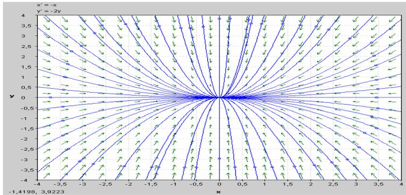
Las soluciones fluyen hacia el punto crítico (0,0) asintóticamente estable.
