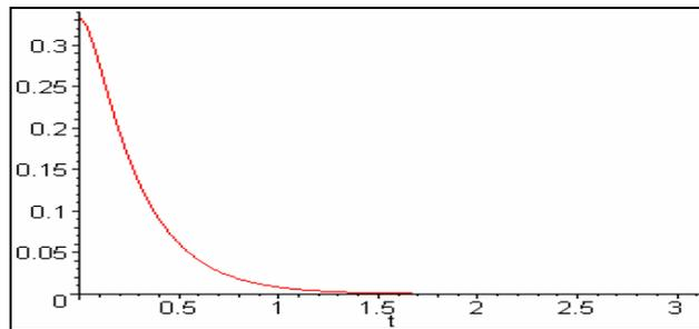
No hay oscilaciones, el peso tiene tanto amortiguamiento que solo retorna gradualmente a la posición del equilibrio sin pasar por esta. Este tipo de movimiento se llama movimiento sobre amortiguado.
